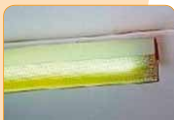
Diffuseur prismatique pertes = 60 %
